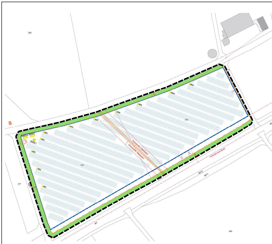
Abbildung 1: Modulbelegungsplan Solarpark Ustersbach [15]
